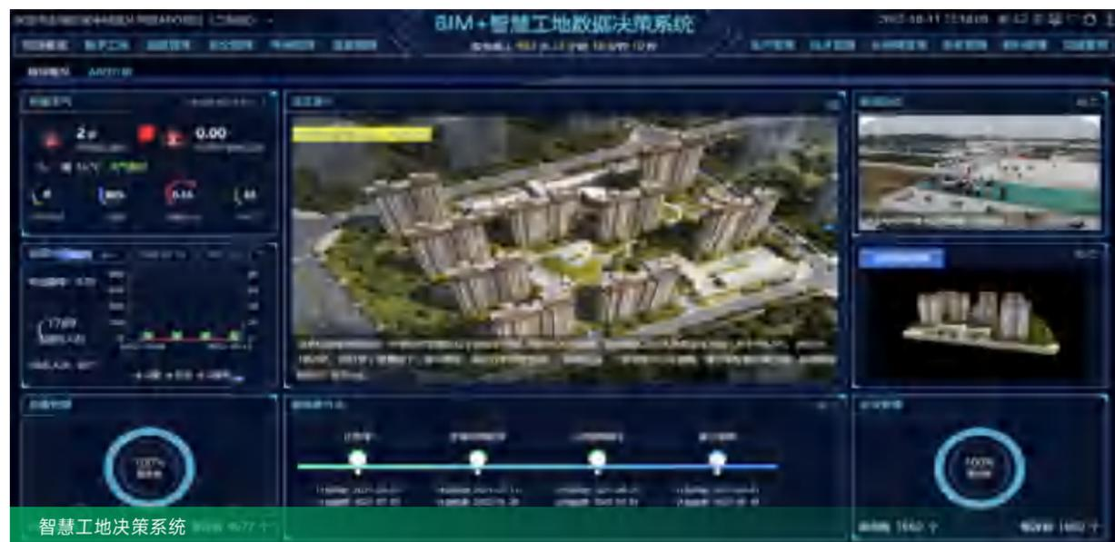
环境监测系统实时捕捉现场的风速、温度和颗粒物等关键参数，将这些数据即时上传至智慧工地系统。当监测参数超过预设安全阈值，系统将立即触发报警机制，并与喷淋设备实现智能联动，自动启动降尘措施，有效控制施工现场的扬尘问题。
