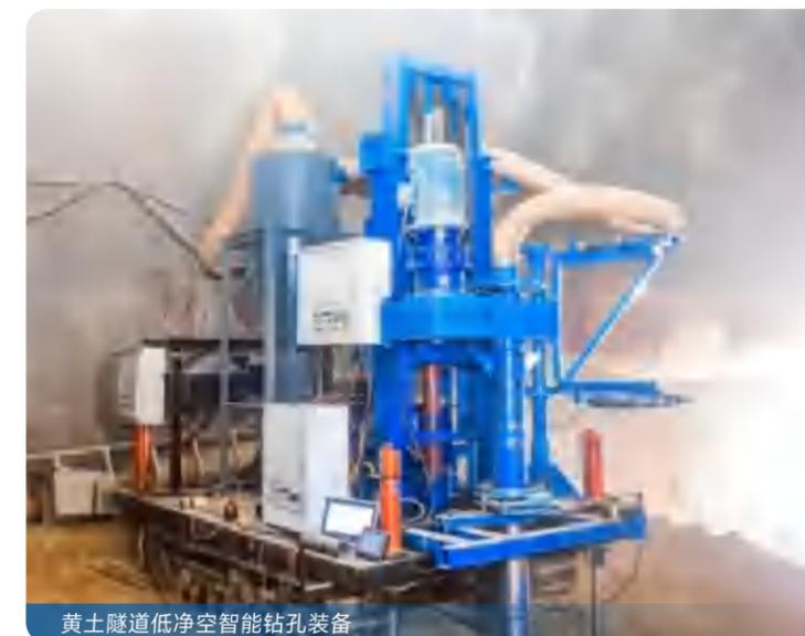
黄土隧道低净空智能钻孔装备
